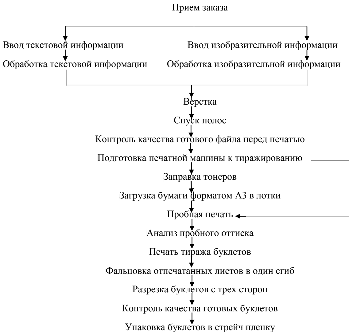
Рисунок 1 – Технологическая схема изготовления буклетов
